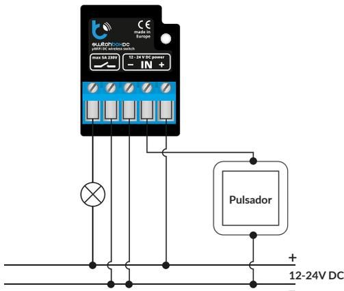
Circuito controlado separado, posibilidad de controlar dispositivos de 230V:
